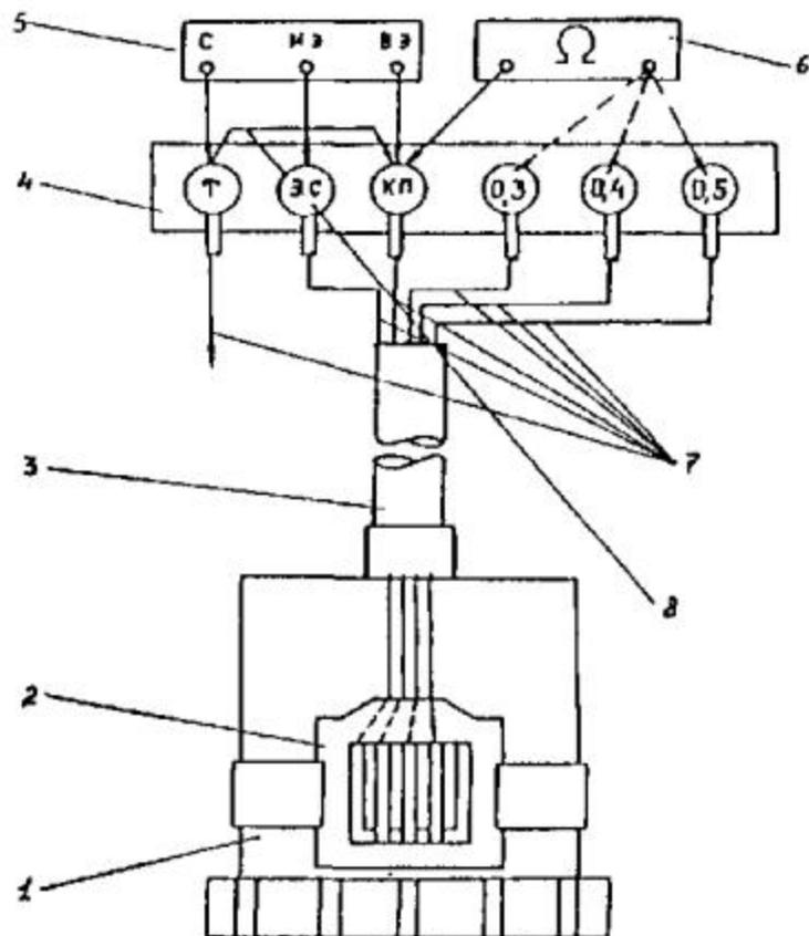
Рис. ОЗ. Схема контроля электропроводности индикаторов и измерения поляризационного потенциала трубопровода при установке блока индикаторов на стационарном электроде сравнения
