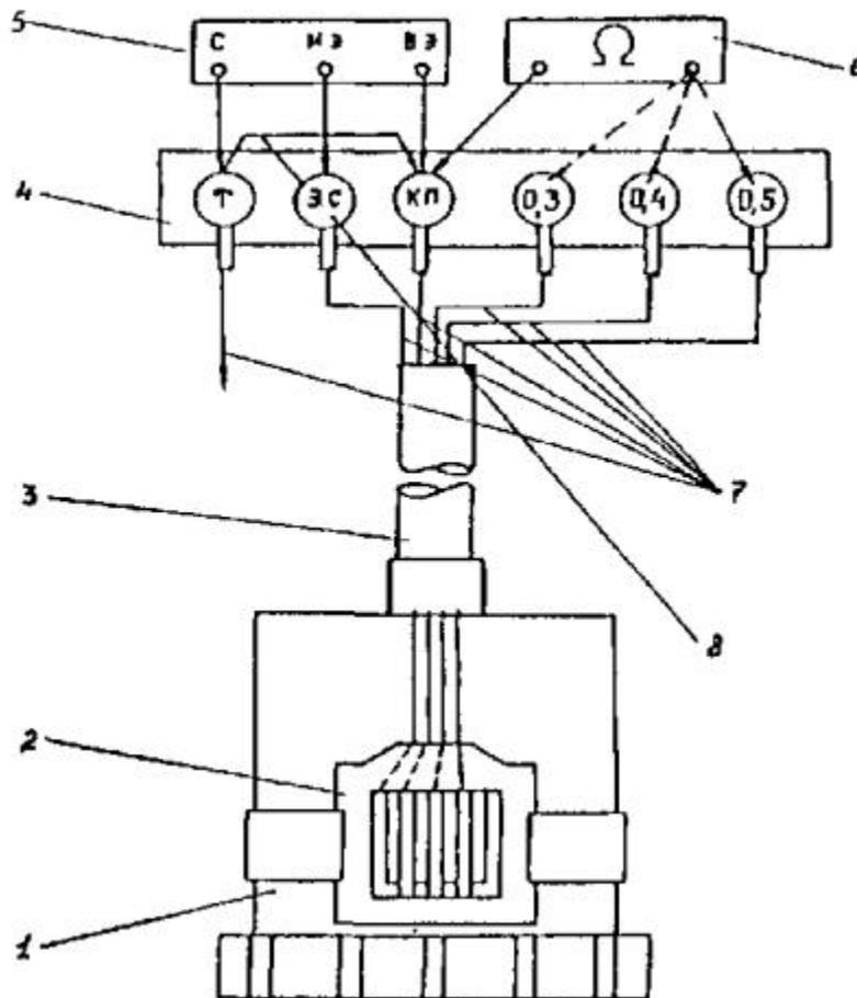
Рис. О5. Схема установки и подключения индикаторов локальной коррозии при контроле опасности локальной коррозии трубопровода, оборудованного средствами ЭХЗ
