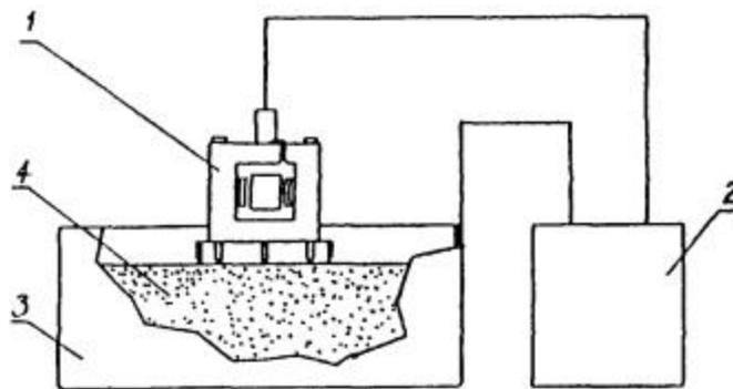
**Рис. 4.4.1** Схема измерения переходного электрического сопротивления электродов сравнения
