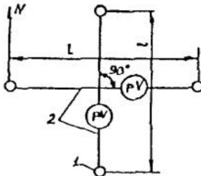
Рис. 4.2.2 Схема электрических измерений для обнаружения блуждающих токов в земле
