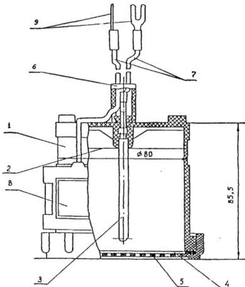
**Рис. Н1. Стационарный медносульфатный электрод сравнения типа ЭНС-1 и ЭСН-МС**
