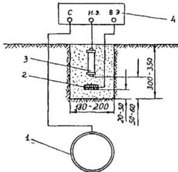
Рис. 4.7.2 Схема измерения поляризационного потенциала на нестационарных КИПах
