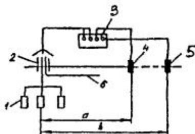
Рис. 4.7.3 Измерение сопротивления растеканию тока анодного заземления
