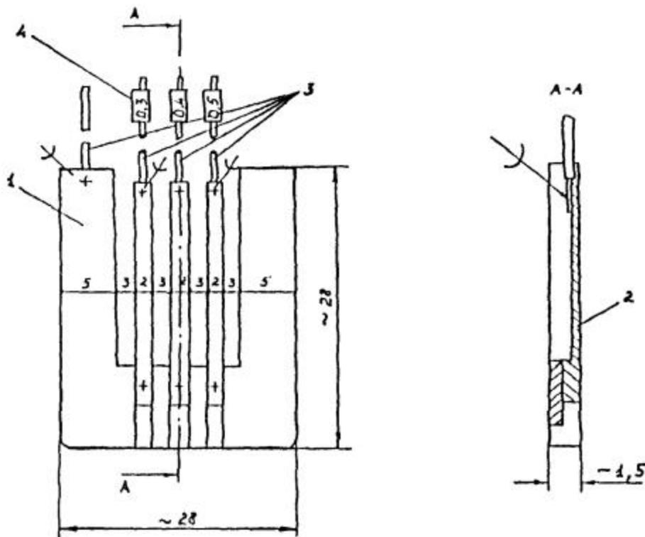
Рис. О1. Блок индикаторов (без корпуса)
